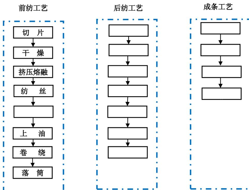
复合短纤维生产工艺图示:
