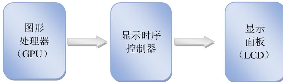
如果理解外部显示接口为外部传输接口，则显示时序控制器可理解为笔记本电脑、平板电脑、一体机以及智能手机等产品中主板（GPU）到显示面板的内部传输接口。
