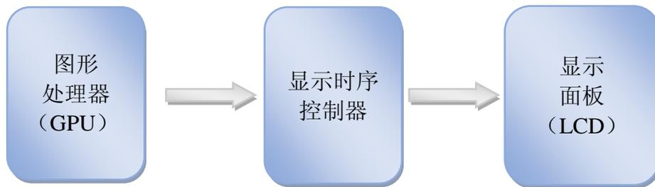
如果理解外部显示接口为外部传输接口，则显示时序控制器可理解为笔记本电脑、平板电脑、一体机以及智能手机等产品中主板（GPU）与显示面板的内部传输接口。
