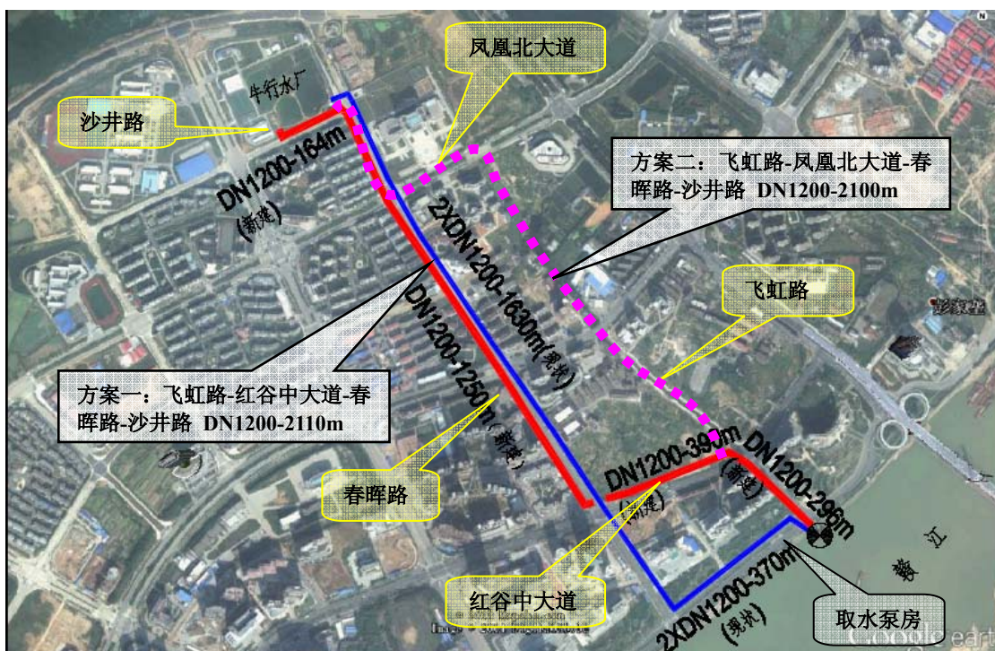
图 6-2 牛行水厂现状和拟建原水管道路线图
