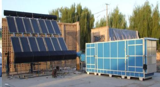
混联式太阳能多功能果蔬干燥成套设备
