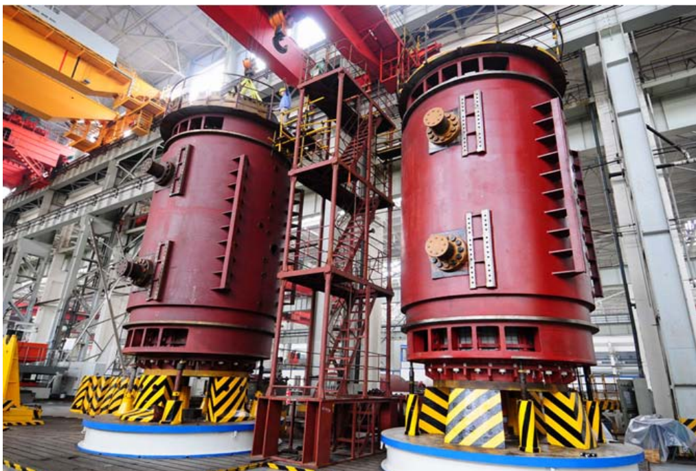
两台 600MW 汽轮发电机定子正在叠片
