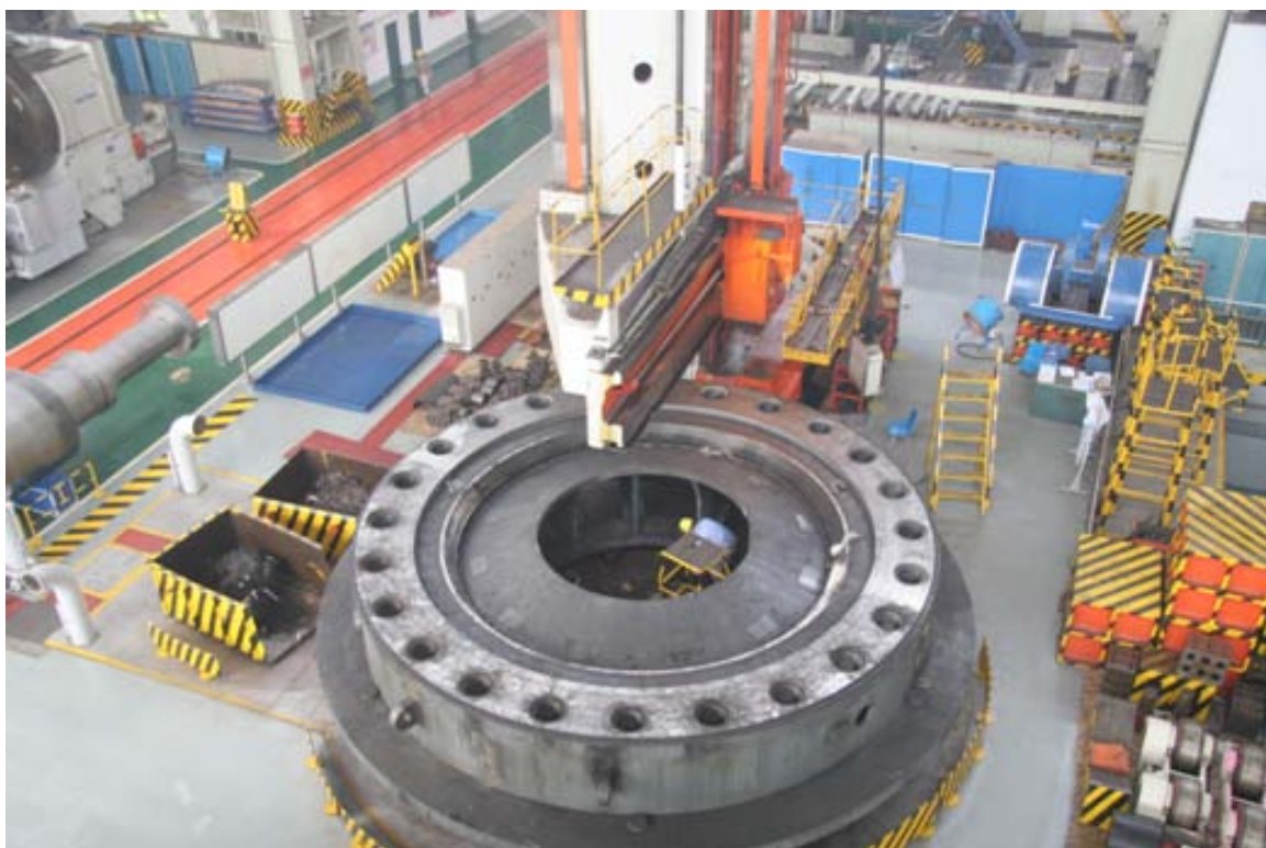
锦屏电站水轮机顶盖在立车上加工
