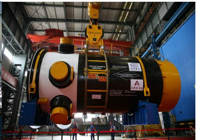
国产首台百万千瓦级核电反应堆压力容器在东方重机产出
