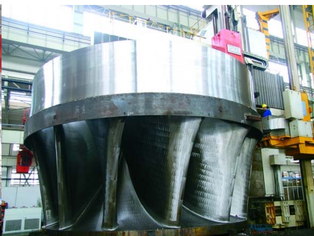
三峡地下厂房首台转轮正在加工
