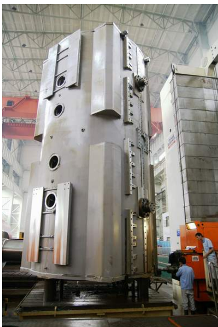
岭澳二期核电发电机定子机座
