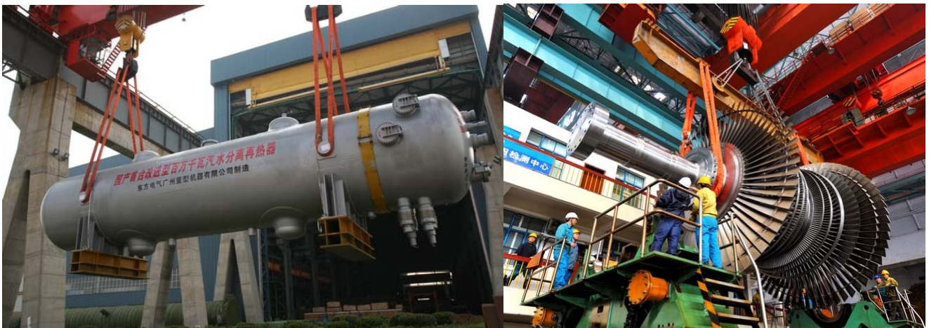
国产首台百万千瓦汽水分离再热器
