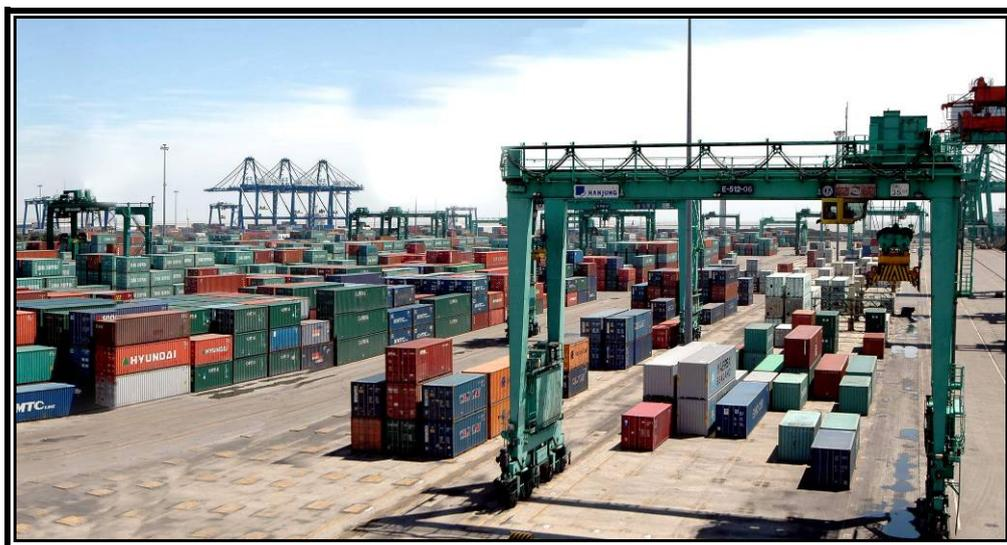
太平洋公司“油改电”改造工作采用基于直流供电的低架滑触线形式并采用共用能量回馈系统，申请发明专利“直流供电及共用能量回馈系统的轮胎式集装箱龙门起重机”，于 2009 年 12 月底完成了第
