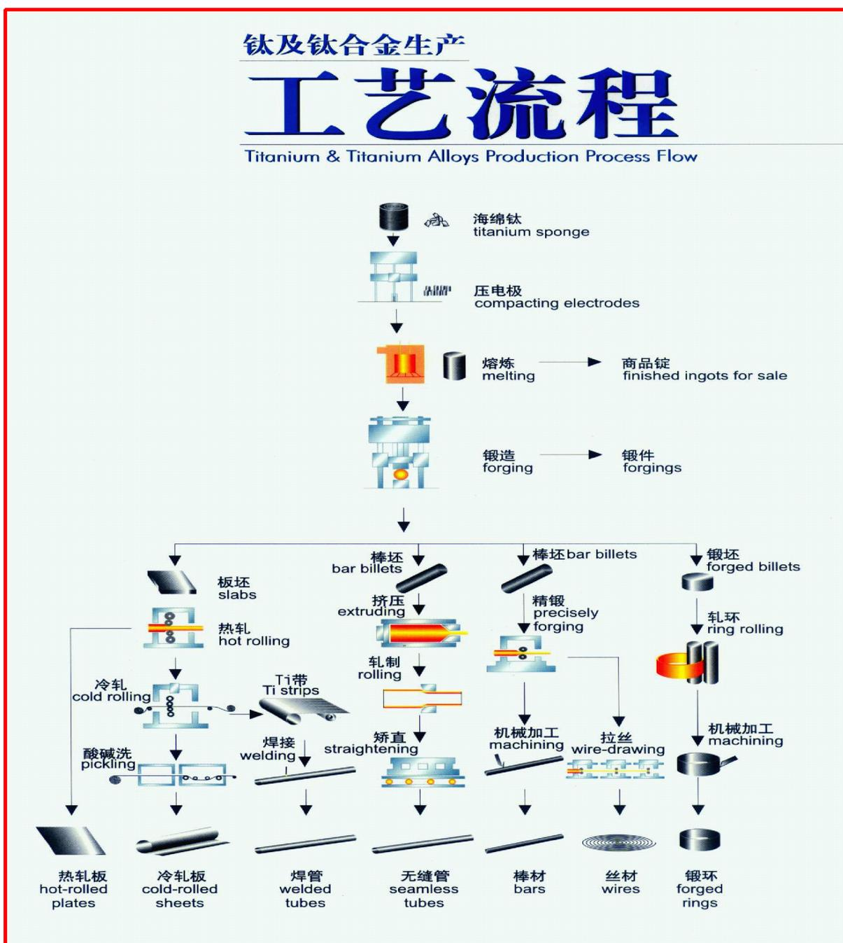
钛及钛合金生产的工艺流程框架图：
