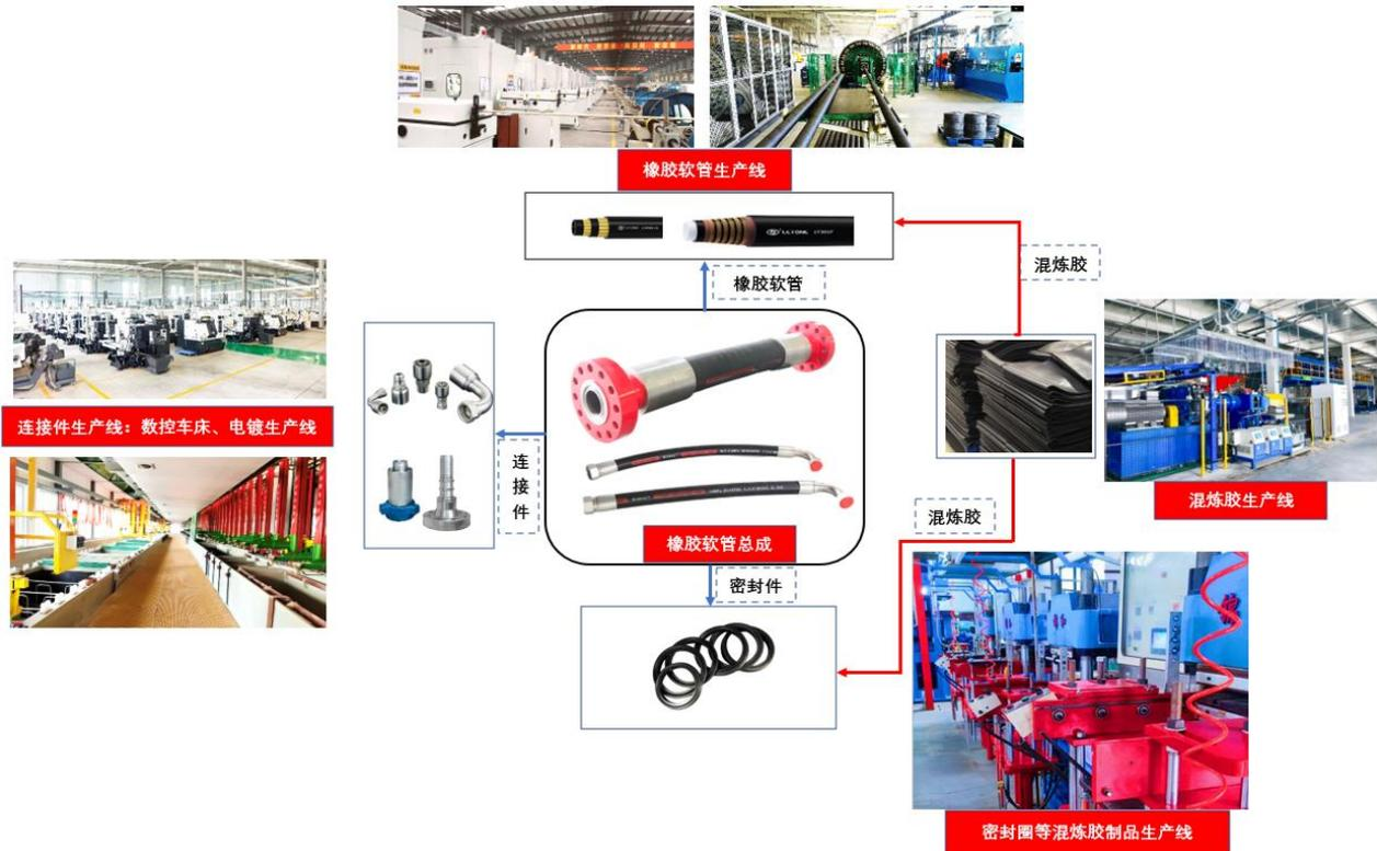
公司橡胶软管及软管总成产品广泛应用于工程机械、煤矿机械、农业机械、化工、石油天然气钻采、食品、风电等行业领域，产品主要用于实现各类设备动力传输或者流体介质输送的目的。
