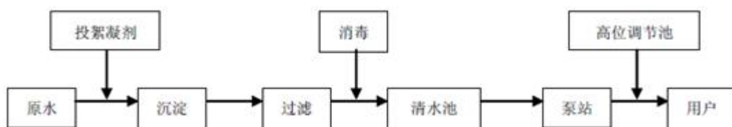
图：自来水生产工艺流程图
