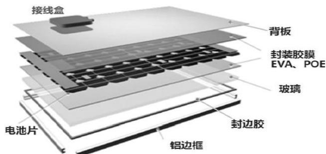
在大力发展新能源产业的背景下，现阶段公司主营的高分子薄膜材料主要为新能源行业中的光伏产业进行配套，主要产品包括透明 EVA 胶膜、白色增效 EVA 胶膜、POE 胶膜及其他高分子胶膜等。
