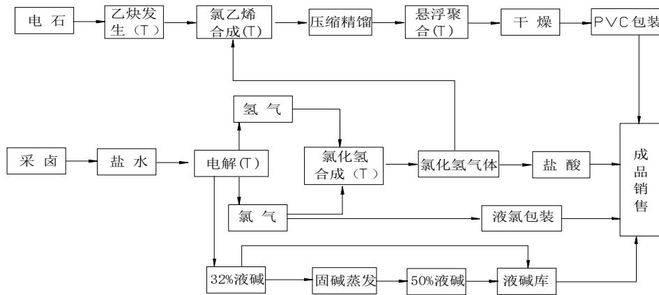
金泰氯碱借鉴吸收了国内外同行业先进的氯碱化工技术，目前属于国内同行业中应用较为成功的一家；其烧碱生产采用的全卤制碱和盐酸合成炉副产蒸汽工艺、用零极距离子膜制碱工艺和膜式蒸发工艺，目前属于国际最先进的技术，单位烧碱电能及蒸汽消耗处于国内同行业前列；其 5 万吨/年微粒碱装置是中国大陆的第一套；聚氯乙烯生产采用 70m<sup>3</sup>、105m<sup>3</sup> 聚合釜及旋风干燥工艺，装置产能大，产品品质高；污水处理系统结合生化处理与反渗透处理两种先进技术，可实现水资源高效利用。
