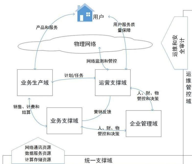
在云平台中，统一支撑域和运维管控域是整个云平台的基础框架。前者为平台各子系统提供可共享的计算、存储和数据服务等资源，主要包括中心机房、云计算基础框架、大数据分析系统等；后者为平台各子系统提供统一的运维管控、网络安全控制、用户认证和行为审计等工具，属于后台支撑系统。
