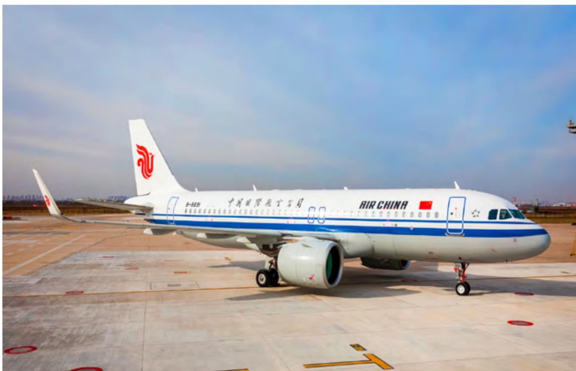
空客 320NEO 采用新一代 PW1100G/LEAP-1A 发动机，发动机风扇尺寸更大，加装新一代鲨鳍小翼，增加了飞行安全裕度
