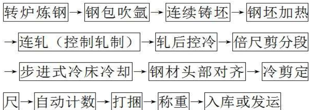
图 2-1：直条钢筋生产工艺流程
